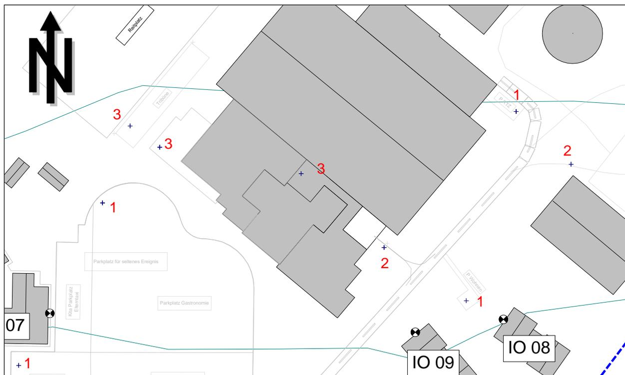
**Abb. 9** Lage der Schallquellen („kurzzeitige Geräuschspitzen“): 1 – Kofferraumklappe PKW; 2 – Druckluftbremse LKW; 3 – Lautes Rufen
